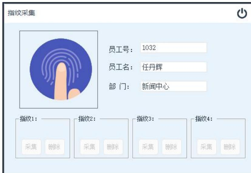
如上图所示，每个用户最多可以登记 4 枚指纹。点击对应指纹名称下的“采集”按钮然后将手指轻按指纹仪扫描区，下图中发白区玻璃区域。
